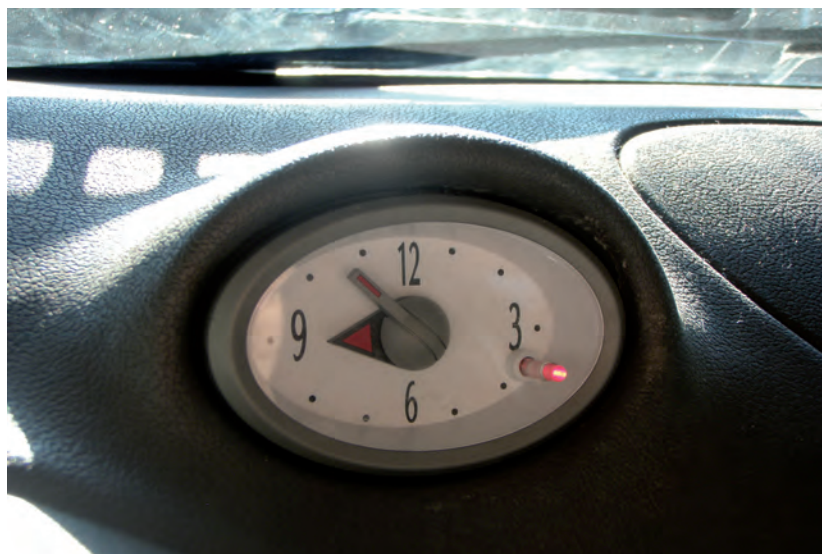
7 Příklad kontrolky PATS ve vozidle Ford Ka.
