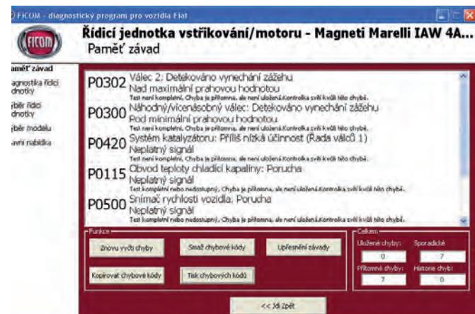
8 Paměť řídicí jednotky motoru obsahovala sedm chyb, u žádných navíc nechyběly další zpřesňující informace.
