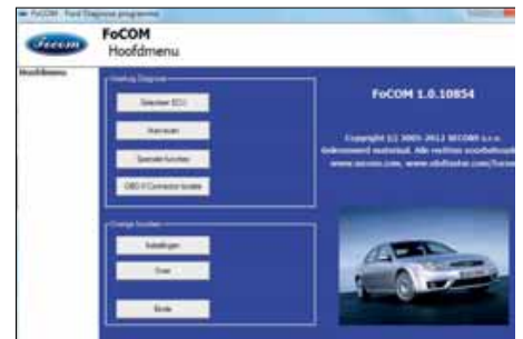
FoCom is een pc-gebaseerde diagnose tool met een overzichtelijke user-interface.
