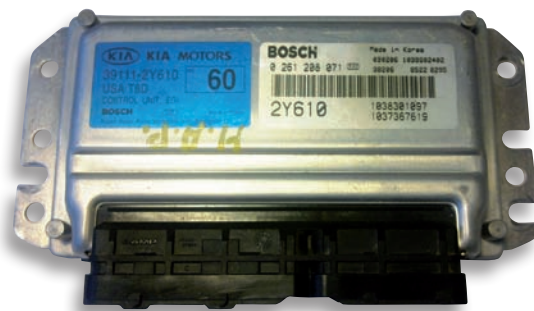
7 Zážehové motory malých objemů používají zejména jednotky Bosch/Kefico M7.9.1.
